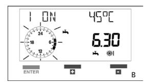
Программирование интервалов времени всегда начинается со времени включения (ON), которое обозначается символом и заканчивается временем отключения (OFF), которое обозначается символом .
