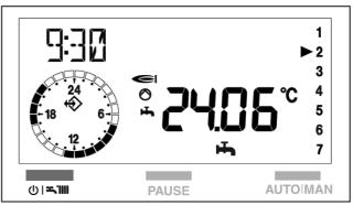
Дистанционная панель управления включится и перейдет в состояние, в котором она находилась перед отключением: если она находилась в режиме «зима» \*\*, то она снова включится в зимнем режиме; если она находилась в режиме «лето» —, то она снова включится в этом режиме.
